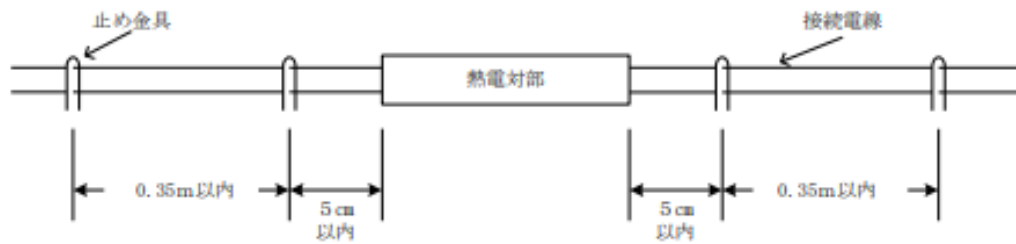
差動式分布型（熱電対式）感知器の取付け例
