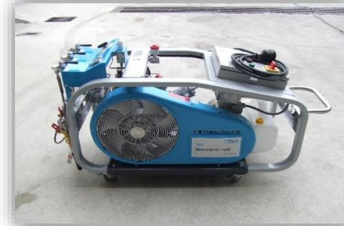
大東署及び四條畷署に配備していた空気充填機を移動式1台に効率化。空気呼吸器への充填が火災現場でも可能になりました。
