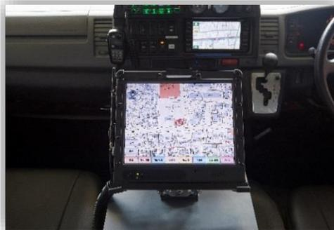
車両の動態や位置情報を指令センターに送信する装置で、各車両の位置情報を把握しているセンターから出場指令が送信されます。
